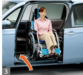
3 上昇スイッチを押し続けると、専用車いすが上昇を始めるとともに固定装置で固縛されます。
