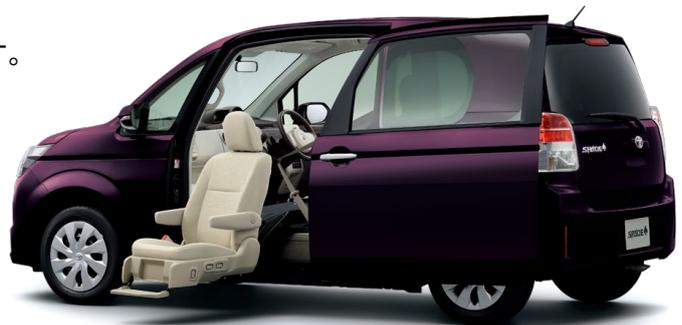
Photo: F 2WD 助手席リフトアップシート車“Aタイプ”。ボディカラーはボルドーマイカメタリック(3R9)。
