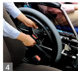
4 白いストラップを引いて、バックルを起こし、車輪の外側でバックルにカチッと音がするまで差し込みます。
