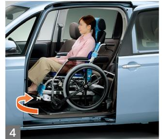
4 さらに上昇スイッチを押し続けると専用車いすは車内へと収納されます。
