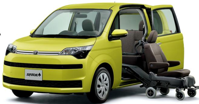
脱着シート仕様〈手動式〉+手動車いす用収納装置〈電動式〉
