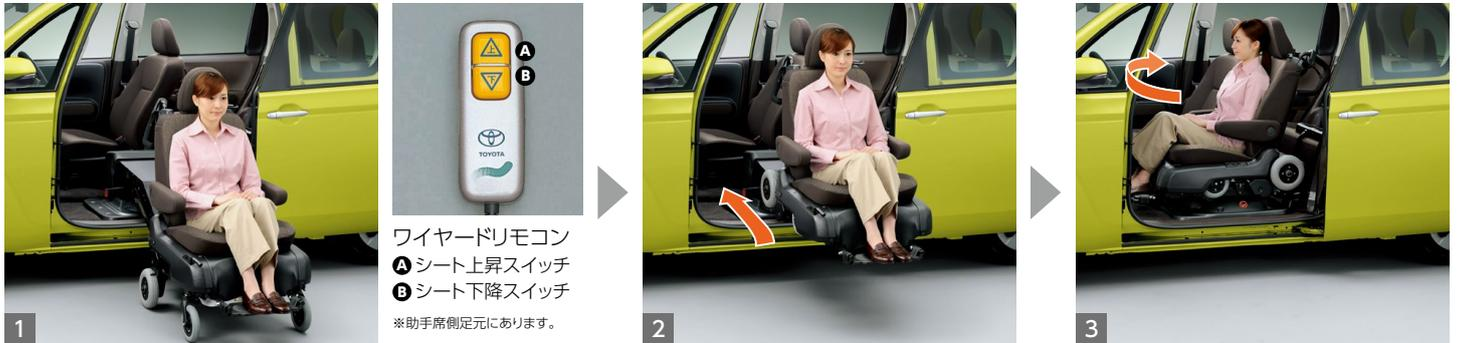
スライドドアを全開にし、ワイヤードリモコンの下降スイッチを押し続けて、サイドアクセスユニットを引き出し、脱着シートをセットします。
