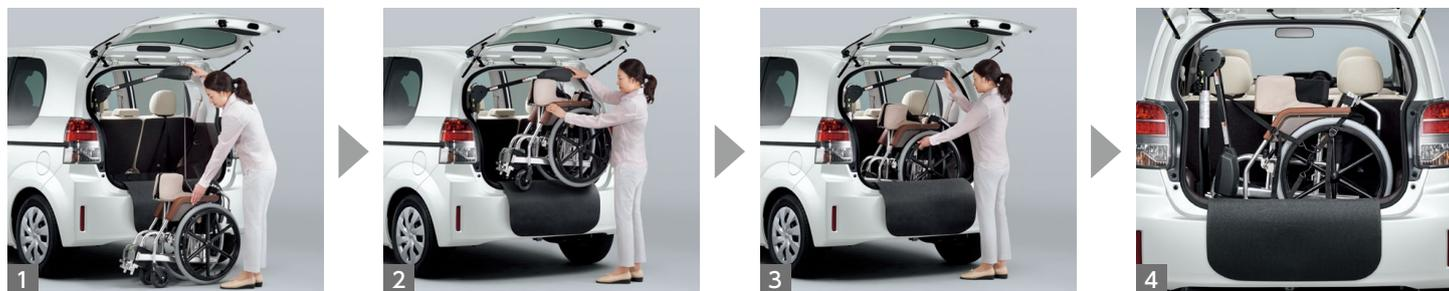
ガードマットを取り付け、収納装置のアームを起して車外に向け、吊りベルトを車いすに掛けます。
