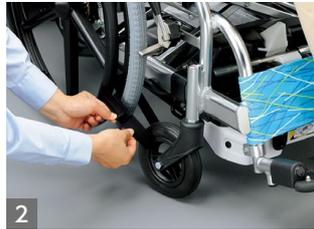
固定用ベルトで専用車いすの前輪を固定します。
