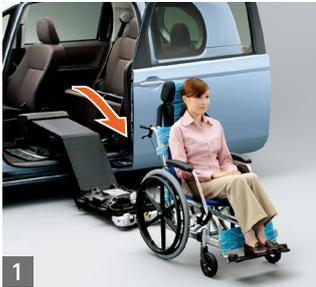
1 スライドドアを全開にし、ワイヤードリモコンの下降スイッチを押し続けて、サイドアクセスユニットを引き出します。
