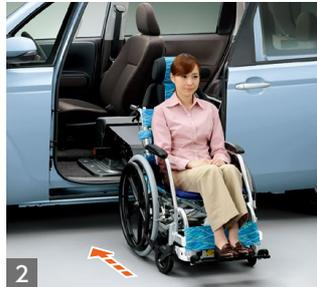
2 専用車いすをサイドアクセスユニットにセットし、固定装置のフックを掛け、固定用ベルトで専用車いすの前輪を固定します。
