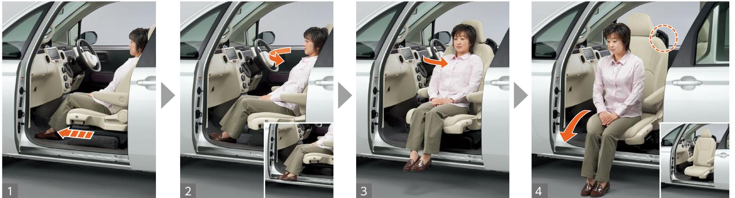
1 回転スライドレバーを引き上げて、シートを最前端までスライドさせます。
