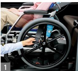
1 シートベルトを引き出して、左側のアームレストの下側と車輪の中(スポークの間)を通します。
