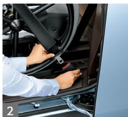
2 車輪の外側でバックルにカチッと音がするまで差し込みます。
