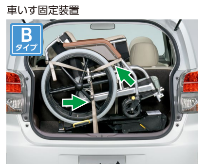
上側の固定ベルトに下側の固定ベルトを引っかけて車いすを固定します。 ⚠️ 走行前に必ず車いす固定ベルトを固定してください。
