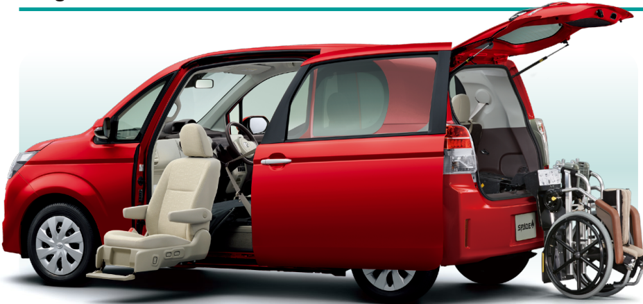
Photo: F 2WD 助手席リフトアップシート車“Bタイプ”。ボディカラーはスーパーレッドV(3P0)。内装色のフロアージュは設定色(ご注文時に指定が必要です。指定がない場合はプラムになります)。 オーディオレスカーバ<1,200円(取付費が別途必要)>、専用車いす<163,000円>は販売店装着オプション。
