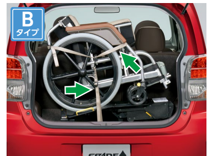
上側の固定ベルトに下側の固定ベルトを引っかけて車いすを固定します。
