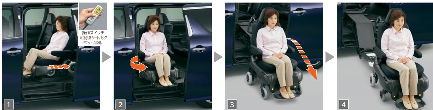
スライドドアを全開にして、操作スイッチを押し続けると、回転開始位置までシートが後方にスライドして、背もたれ角度を自動的に調整します。
