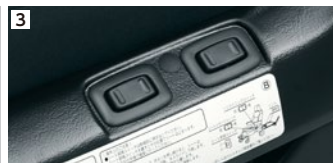
3 シート前後スライドスイッチ& シートリクライニングスイッチ ※車外でのシートリクライニング操作はできません。
