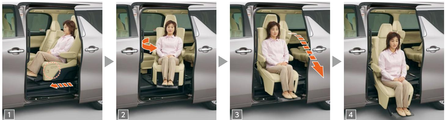
1 スライドドアを全開にして、ワイヤレスリモコンスイッチ(またはシート昇降スイッチ)を押し続けると、回転開始位置までシートがスライドして、背もたれ角度を自動的に調整します。
