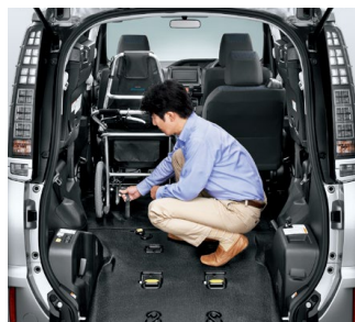
⑦車いすのブレーキをかけ、後側の車いす固定装置(電動)のフックを取り出し、車いすの後部フレーム(左右2ヶ所)に掛けます。固定装置スイッチのロック側を押し続け、固縛します。
