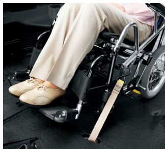
⑥車いすの後輪中央を床面のマークに合わせ、車いすを止めます。セーフティベルトにより、車いすの前側が固縛されます。 ※写真はメーカーオプションの電動ウインチ装着車です。
