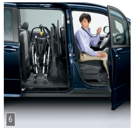
リモコン操作でウェルライドを収納し、運転席側パワースライドドア・運転席ドアを閉めます。
