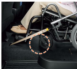
⑥車いすの前輪が車輪止めに到達したら、車いすを止めます。セーフティベルトにより、車いすの前側が固縛されます。 ※写真はメーカーオプションの電動ウインチ装着車です。
