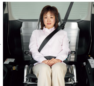
⑧車いす用シートベルトを着用します。スロープを格納し、車高調整スイッチの「上」を押し、車高復帰します。(上がりと自動停止します)
