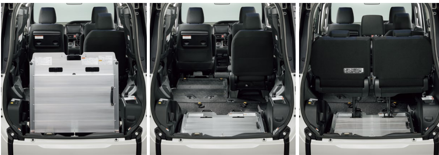
手動スロープ前倒れ機能 (直立時) (前倒れ時) (サードシート使用時)
