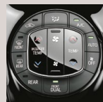
フロントオートエアコン (左右独立温度 コントロール+ 「ナノイ」+蓄冷 エバポレーター付)
