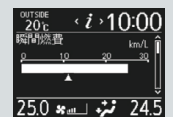
マルチインフォメーション ディスプレイ (3.5インチモノクロ)
