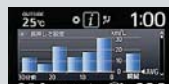
マルチインフォメーション ディスプレイ (4.2インチTFTカラー)
