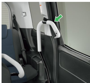
①スライドドア乗降口手すり
