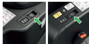
ウインチスイッチ セカド席用(タイプI) サード席用(タイプII)
