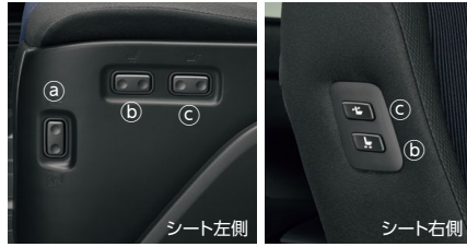
①シート操作スイッチ ①シート昇降スイッチ ②シート前後スライドスイッチ ③シートリクライニングスイッチ 右席や後席からも操作が可能です。
