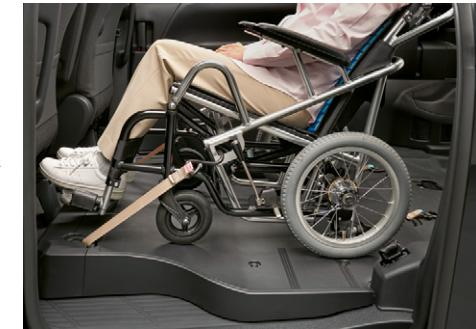
⑤フロアのガイドラインを目安にセカンド席まで進み、車いすの後輪中央を床面の停止線に合わせ停止します。セーフティベルトにより、車いすの前側が固定されます。
