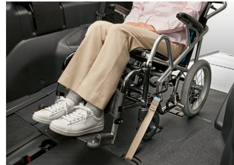
⑤車いすの後輪中央を床面の停止線に合わせ停止します。
