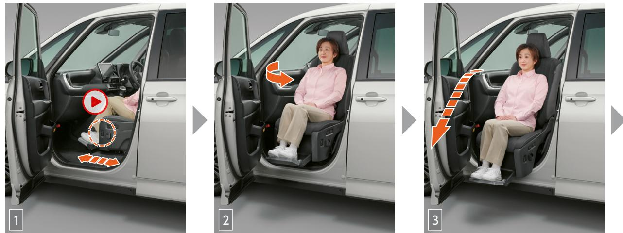
助手席ドアを全開にして、ワイヤレスリモコンスイッチ(またはシート昇降スイッチ)を押し続けると、回転開始位置までシートがスライドして、背もたれ角度を自動的に調整します。
