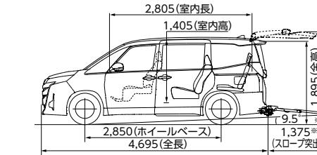
※1 バックドア開放時、地上からのバックドアの高さは標準車と同じです。 ※2 車高降下時の地上線です。 ※3 車高降下時の寸法です。
