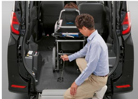
⑥車いすのブレーキをかけます。その後、後側の車いす固定装置(電動)のフックを取り出し、車いすの後部フレーム(左右2か所)に掛け、車いす固定スイッチを押して車いすを固定します。
