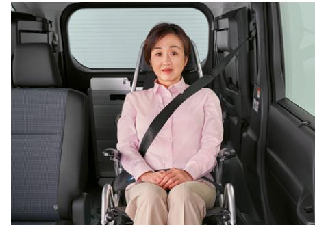
⑦車いす用シートベルトを着用します。スロープを格納し、バックドアを閉めると自動的に車高復帰します(運動モード時)。(車高は上がりきると自動停止します)
