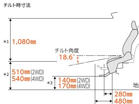
\*1. チルト後の座面中央部高さからドア開口部上端までの寸法です。
