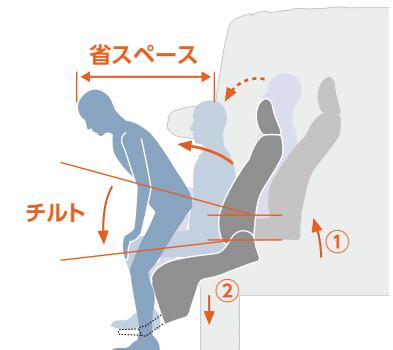
サイドリフトアップチルトシート 操作の流れ ※シートが干渉して操作ができない場合がありますので、操作をする前に助手席シートを調整する必要があります。 ●安全のため各操作は介助の方が確実に行ってください。 ※写真は降車時の手順を説明しています。乗車時は逆の手順で行ってください。[参考]写真のモデルの身長は150cmです。
