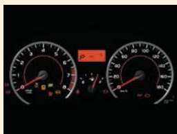
● アナログ コンビネーションメーター (照度コントロール& ドライブモニター付)
