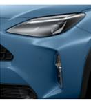
プロジェクター式ハロゲンヘッドランプ(マニュアルレベリング機能付)+ターンランプ+LEDクリアランスランプ+LEDデイタイムランニングランプ<br>■写真はHYBRID X。                                           |                                                                                                                                                             |
