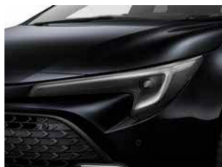
●Bi-Beam LEDヘッドランプ+LEDターンランプ+LEDクリアランスランプ&LEDデイルイト
