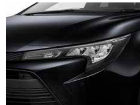
●3灯式LEDヘッドランプ+LEDターンランプ+LEDクリアランスランプ
