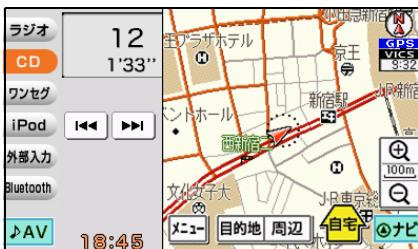
3個以上のGPS衛星からの電波を受信して、自車の現在地を測定することです。本機では、地図画面の右上にGPSマークを表示しています。また、GPS衛星の受信状態により、GPSマークの表示色が切り替わります。（メニュー画面、設定や登録の画面では、「GPS」は表示しません。）
