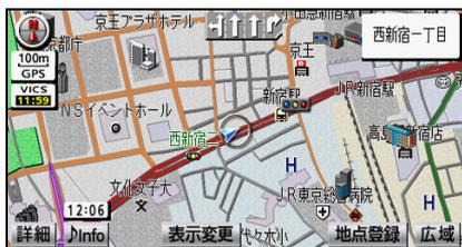
3個以上のGPS衛星からの電波を受信して、自転車の現在地を測定することです。本機では、地図画面の左上にGPSマークを表示しています。また、GPS衛星の受信状態により、GPSマークの表示/非表示が切り替わります。(メニュー画面、設定や登録の画面では、「GPS」は表示しません。)
