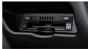
GPS内蔵 ETCアンテナ装着例
