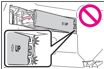
**駆動用電池冷却用吸入口の清掃**
