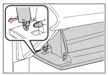
3 グローブボックス側面を内側に 押して上部のツメを片側ずつは ずし、下部のツメをはずしてと りはずす
