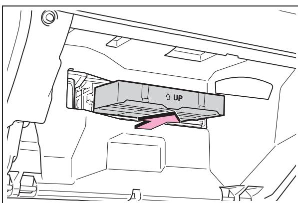
**7 フィルターケースからフィルターを取りはずし、新しいフィルターと交換する**
