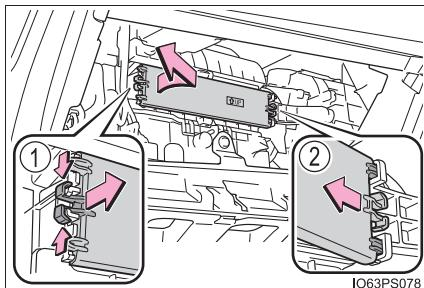
**6 フィルターケースを取りはずす**
