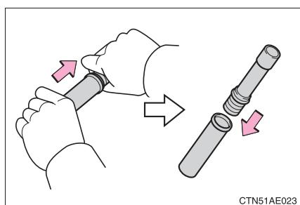
3 先端のフタを取り、すり薬で発炎筒の先端をこすり、着火させる
