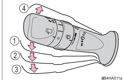
間欠作動を選択しているとき、間欠時間を調整することができます。（間欠時間調整式ワイパー装着車）
