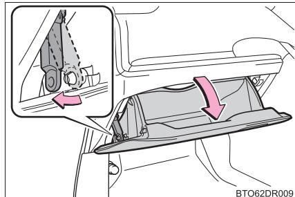
③ グローブボックス側面を内側に押して上部のツメを片側ずつはずし、下部のツメをはずして取りはずす
