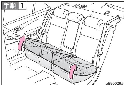
シートクッション前端の外側部分を持ち上げて、ロックを解除する
