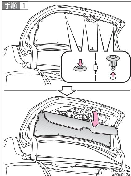
トランクを開け、クリップ（4個）をはずしてカバーをめくる
