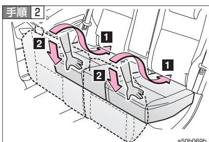
シートクッション後部を背もたれの下端に挿し込み（1）、シートクッション前端を押さえ付けてロックする（2）
