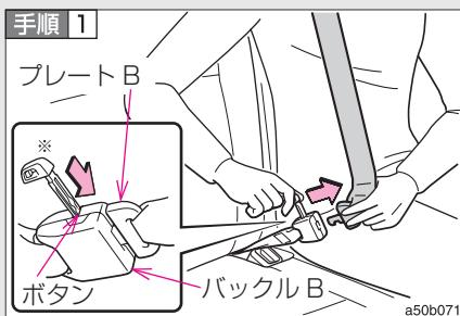
キー（→P. 20）などでバックルBのボタンを押し、プレートBを分離する
