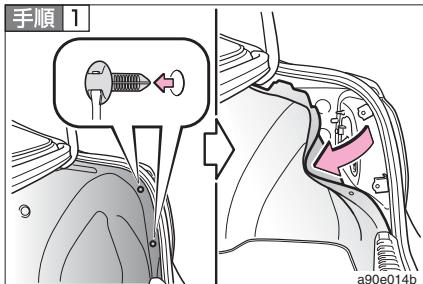
トランクを開け、クリップ（2個）をはずしてカバーをめくる
