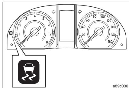
車両が横すべりしそうになったとき、駆動輪が空転したときは、VSC・TRC の作動を表示するため、スリップ表示灯が点滅します。
