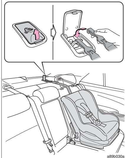
フタを開けて、トップテザーアンカーにフックを固定し、テザーベルトを締める
