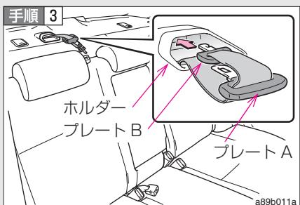
プレート A、B を重ねて、ホルダーに挿し込む
