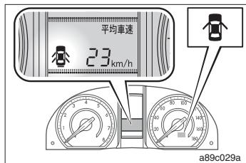
エンジンスイッチが“ON”（スマートエンタリー＆スタートシステム非装着車）、または“エンジンスタートストップ”スイッチがイグニッションONモード（スマートエンタリー＆スタートシステム装着車）のとき、半ドア警告灯（→P. 281）の点灯に併せて表示されます。
