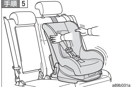
取り付けたチャイルドシートを軽くゆさぶり、確実に固定されてい
