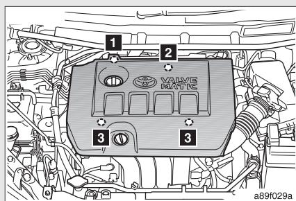
カバーの各部を次の順で上に引き、エンジン側の固定ピンからカバーをはずします。
