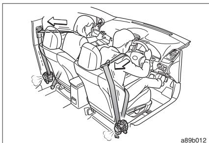
前方から強い衝突を受けたとき、シートベルトを引き込むことで適切な乗員拘束効果を確保します。
