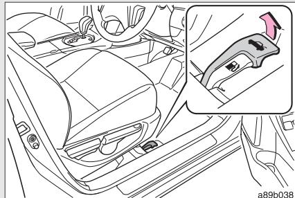
トランクオープナーを引き上げて、トランクのロックを解除する
