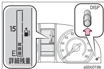
確認するときは、マルチインフォメーションディスプレイに航続可能距離が表示されている状態で、DISPボタン（またはDISPスイッチ※）を押します。
