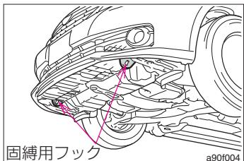
固縛用フックは、船舶固縛で車両を輸送するときに使用するためのものです。けん引には絶対に使用しないでください。
