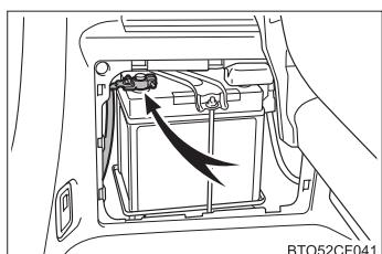
車体側のアース部分（マイナスケーブルの根元）ではなく、必ず補機バッテリー側の端子をはずしてください。
