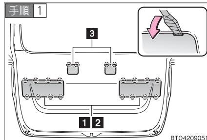
バックドアを開け、交換したい電球のカバーをはずす。
