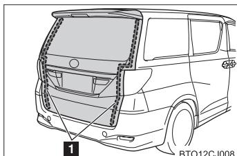
パワーバックドアの左右端部には、センサー（1）がついています。ドアを自動で閉めているときに、挟み込みなどによりセンサーが押されると挟み込み防止機構が作動し、その位置からドアは自動的に反対方向に動き、全開位置で停止します。
