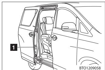
パワースライドドアの前端部には、センサー（1）がついています。ドアを自動で閉めているときに、挟み込みなどによりセンサーが押されると挟み込み防止機構が作動し、その位置からドアは自動的に反対方向に動き、全開位置で停止します。
