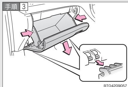
グローブボックス側面を押してツメを片側ずつはずし、下部のツメをはずして取りはずす。
