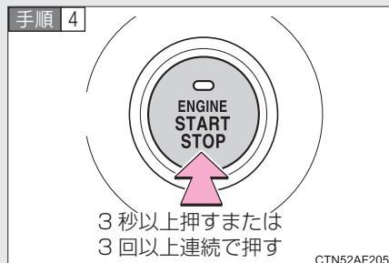
“エンジンスタートストップ”スイッチ＜“パワー”スイッチ＞を3秒以上押し続けるか、素早く3回以上連續で押してエンジン＜ハイブリッドシステム＞を停止する。
