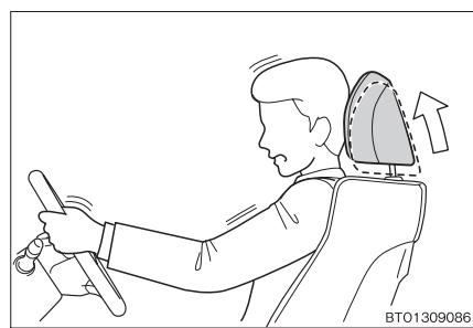
背もたれに強い衝撃を受けると、フロント席乗員のむち打ちの症状を軽減させるためにヘッドレストが少し前方上側に動きます。
