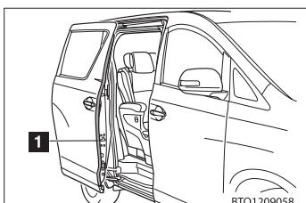
パワースライドドア前端部のセンサー（1）を刃物などの鋭利なもので傷つけないよう注意してください。センサーが切断されると自動で閉めることができなくなります。また、自動で閉めているときにセンサーが切断されると、ドアはただちに停止します。
