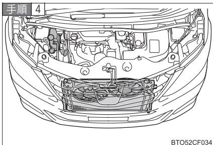
ハイブリッドシステムが十分に冷えてから、冷却水の量やラジエーターコア部（放熱部）の冷却水もれを点検する。
