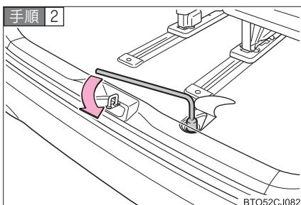
ホイールナットレンチを使用し、ボルトを応急用タイヤ格納具がフックから取りはずせるぐらいでゆるめる。
