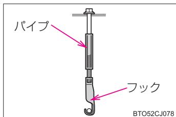
スペアタイヤ格納具をおろす際に、ボルトをゆるめすぎてフックが脱落した場合は、図のようにパイプを入れてからフックを取りつけてください。
