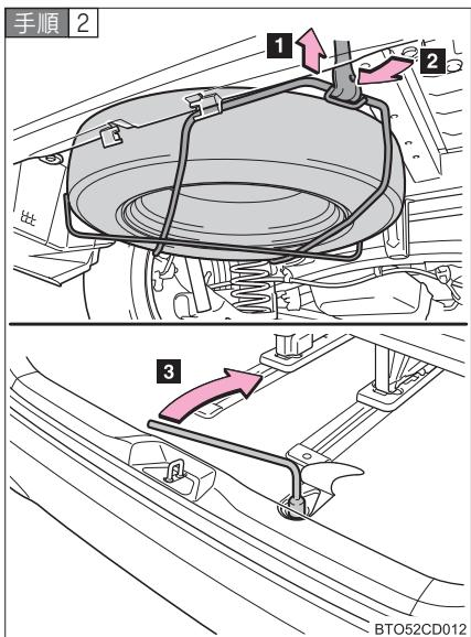
格納具を持ち上げてフックをかけ、ボルトを締めつける。
