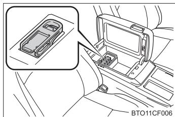
コンソールボックス下部にサービスプラグがあります。サービスプラグはトヨタ販売店で車両の修理時などに、駆動用電池の高電圧を遮断するためのものです。
