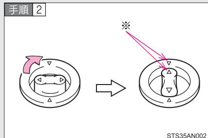
固定フック（クリップ）上部のレバーを回して、フロアマットを固定する。
