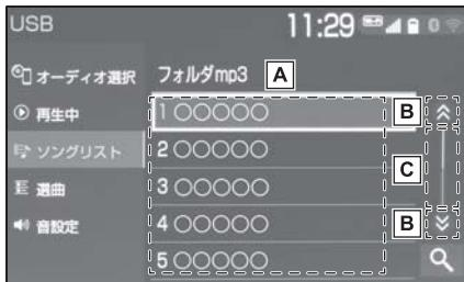
**A** 上下方向にフリック操作すると、リストをスクロールします。
