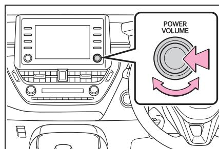
“POWER VOLUME” ノブ：押すごとに電源の ON と OFF が切り替わります。回すと音量が切り替わります。
