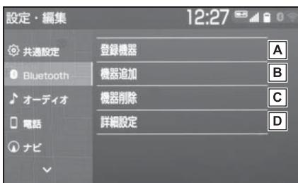
A 使用する Bluetooth 機器の選択、登録済み携帯電話の詳細情報の確認、設定をします。(→P.39)
