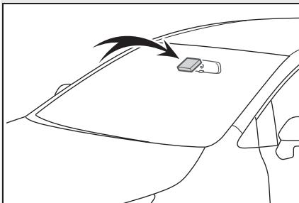
認識した道路標識の制限速度に對し、運転者が制限速度を超過して走行、または禁止行為を行っている等とシステムが判断した場合に、告知表示およびブザー音で運転者に告知します。
