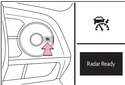
**2** 希望の車速 (約 30km/h 以上) までアクセルペダル操作で加速／減速し、“-SET”スイッチを押して速度を設定する
