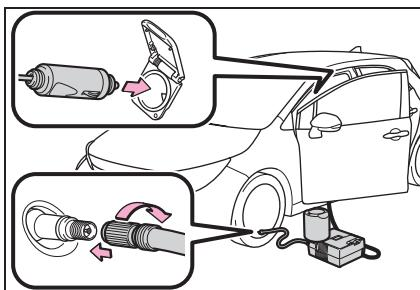
**21** コンプレッサーのスイッチを数秒間 ON にしてから再度 OFF し、空気圧を確認する
