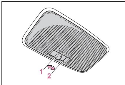
1 ドアの開閉に連動してランプの点灯・消灯を切りかえる
