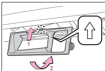
**1 カバーの内側にある矢印を上に向けて、図の点線で示すタブを挿入する**
