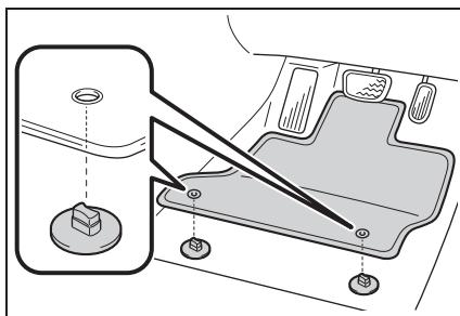
**2 固定フック（クリップ）上部のレバーをまわして、フロアマットを固定する**
