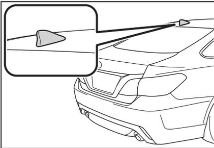
通信モジュール (DCM) は通信アンテナを使用します。
