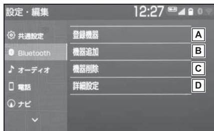
**A** 使用する Bluetooth 機器の選択、登録済み携帯電話の詳細情報の確認、設定をします。(→P.44)
