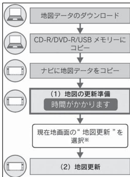
\* “地図更新”を選択しなかった場合、次回エンジンスイッチ <パワースイッチ>をアクセサリモードまたはイグニッション ON モード < ON モード > 時に地図更新を行います。
