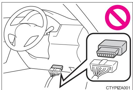
故障診断コネクターなどに、点検整備用の故障診断装置以外の電装品を取り付けないでください。
