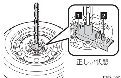
手順 2] 組み付けたジャッキハンドルバーを格納具の穴に挿し込む
