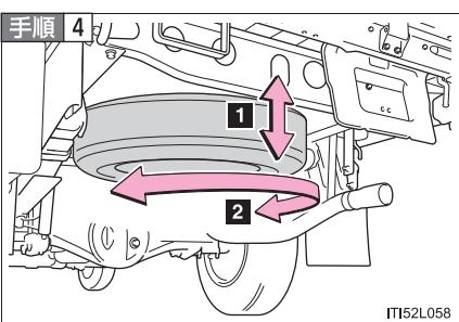
タイヤを巻き上げたら、タイヤが確実に固定されていることを確認する
