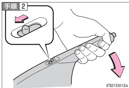
可倒ノブを操作してレバーを下げる
