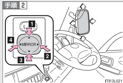
スイッチを操作してミラーの鏡面を調整する
