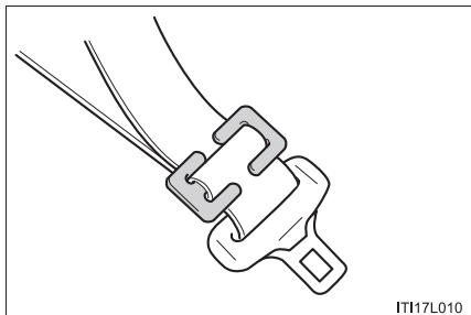
チャイルドシートにシートベルトの固定機構が備っていない場合は、ロッキングクリップ(別売)を使用して固定する
