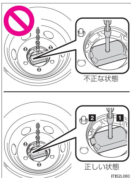
ツメをホイールの穴にかけてアンカープレートを取り付け、ジャッキハンドルをまわして鎖のたるみをなくす
