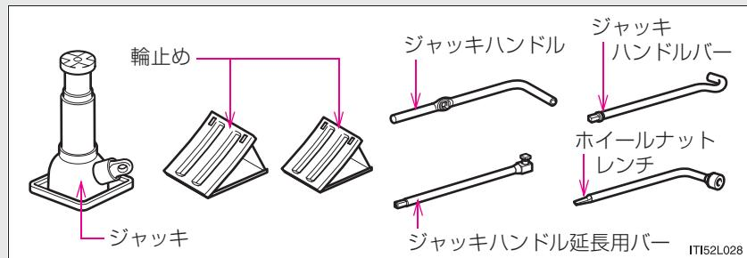
■ 搭載工具 (リヤダブルタイヤ車)
