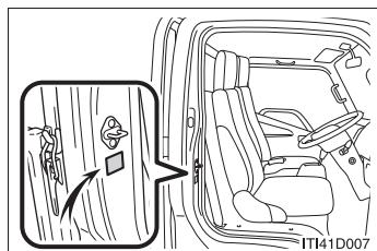
タイヤの指定空気圧／タイヤサイズは、運転席側のタイヤ空気圧ラベルで確認してください。
