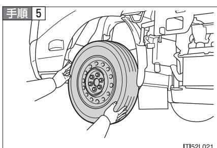
シングルタイヤはナット、ダブルタイヤはナットおよびストップボルトすべてを取りはずし、タイヤを取りはずす
