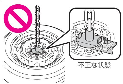
ツメをホイールの穴にかけてアンカープレートを取り付け、ジャッキハンドルをまわして鎖のたるみをなくす
