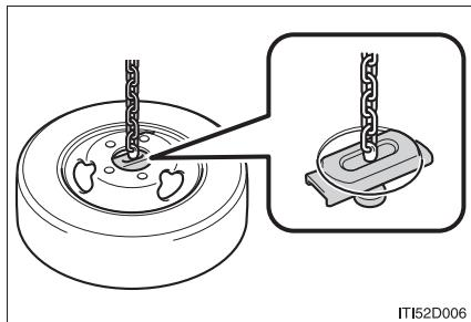
ホイール穴に格納具のアンカープレートを取り付け、ジャッキハンドルをまわして鎖のたるみをなくす
