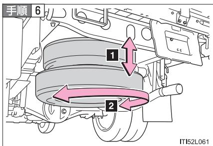
タイヤを巻き上げたら、タイヤが確実に固定されていることを確認する
