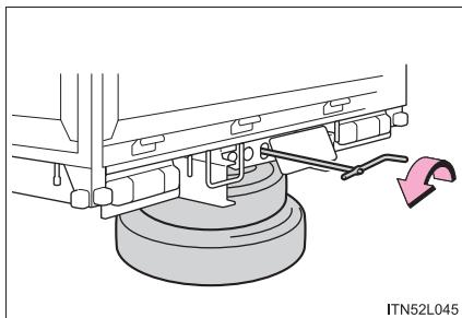
手順 3] おろしたスペアタイヤ／応急用タイヤからアンカープレートをはずす
