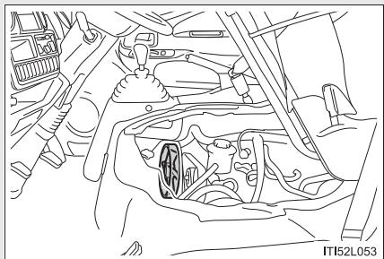
**手順 5** 冷却水が不足している場合は、冷却水を補給する (→P. 347)
