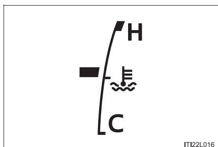
エンジンの冷却水温度に応じてバーが移動します。
