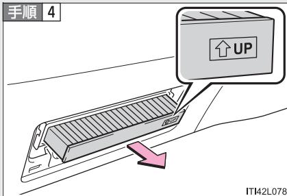
フィルターを取りはずし、点検または新しいフィルターと交換する
