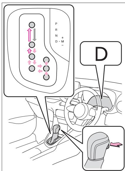
←：エンジンスイッチがONの状態で、ブレーキペダルを踏んだままシフトレバーのボタンを押しながら操作します。※
