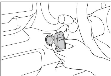
3 オートマチック車はブレーキペダル、マニュアル車はクラッチペダルをしっかりと踏み込んで、マルチインフォメーションディスプレイに が表示されていることを確認する
