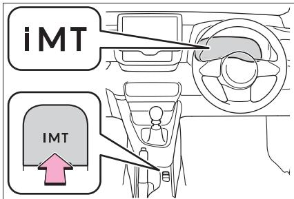
iMT 表示灯（緑）が点灯します。解除するには再度 iMT スイッチを押します。
