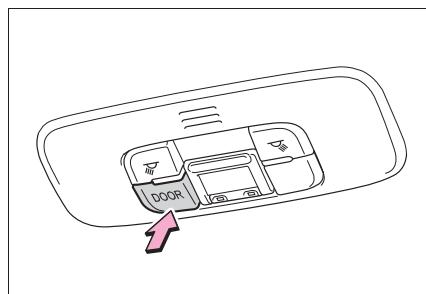
ドアの開閉に連動してランプの点灯・消灯を切りかえる
