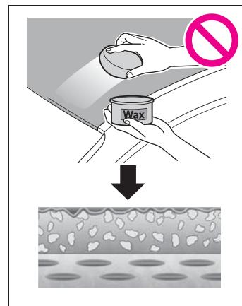
ワックスやコーティング剤は塗装を保護する被膜を形成します。マットクリア塗装では、この被膜が塗装表面の凹凸を埋めてしまいます。その結果、凹凸のある塗装表面が平らに近づくことで表面に艶が出来てしまい、マットな質感が損なわれるおそれがあります。
