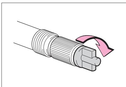
**23** ボトルとコンプレッサーを接続したままラゲージルームに収納する
