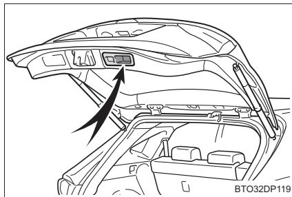
**パワーバックドアの作動を ON / OFF するには（パワーバックドア装着車）**
