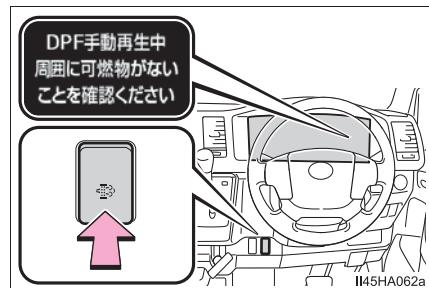
※1 状況により、エンジン回転数が 3000rpm になるまでアクセルペダルを踏み込む必要があります。エンジン冷却水、または排出ガスの温度が低いと、燃焼（再生）処理に時間がかかったり、燃焼（再生）処理ができなかったりする場合があります。
