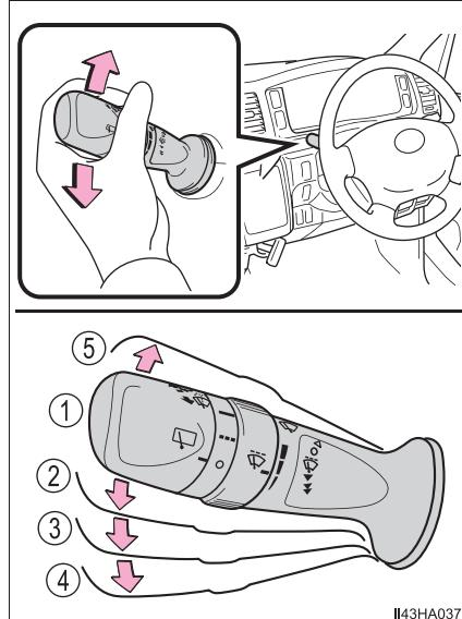
間欠作動 (
