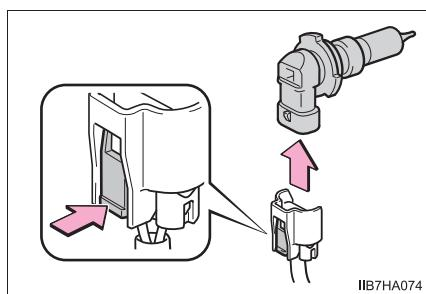
**4** 電球を交換し、ソケットを取り付ける
