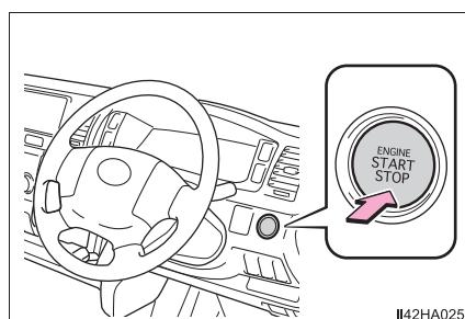
ディーゼル車：
