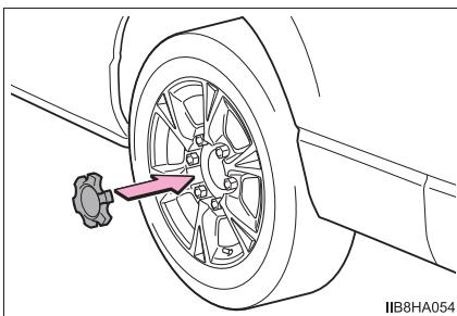
タイヤのバルブ（空気口）に切り欠きを合わせてホイールキャップを確実に取り付けます。
