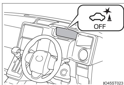
OFF（非作動）に切りかえて、パーキングサポートブレーキ（静止物）を停止させた場合、再度マルチインフォメーションディスプレイの設定画面から ON（作動）に切りかえないとシステムは復帰しません。（パワースイッチの操作では復帰しません）
