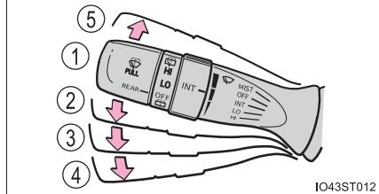
間欠作動を選択しているとき、間欠作動の作動頻度を調整することができます。
