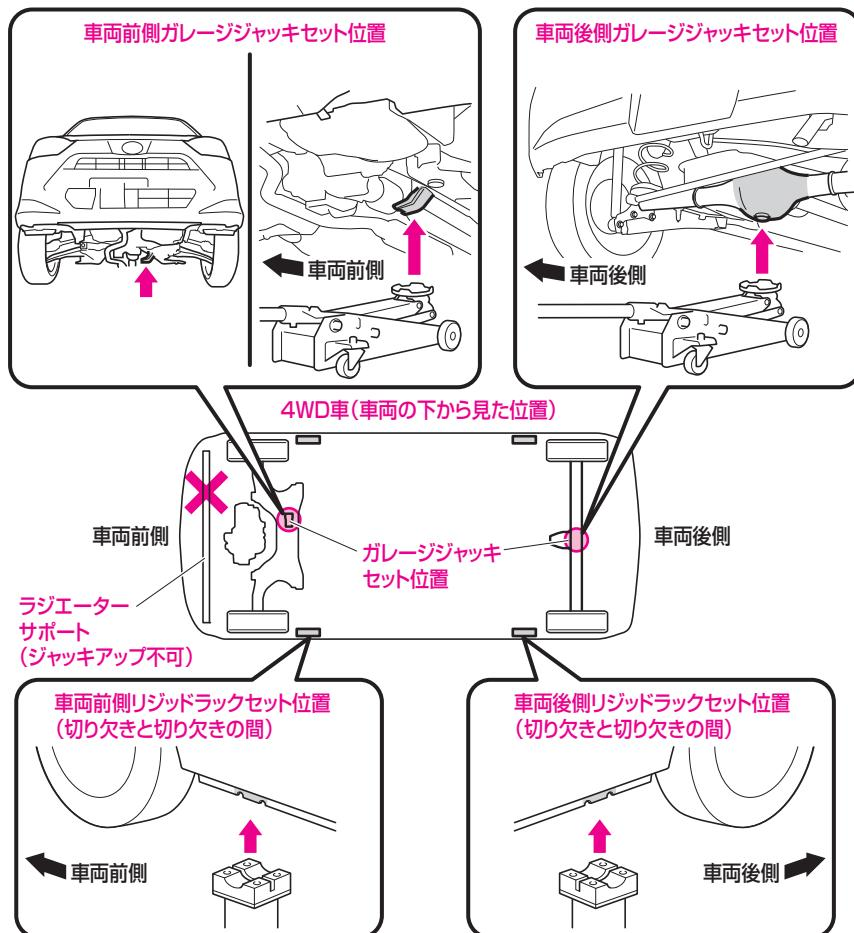
ガレージジャッキを使用する場合は、図のガレージジャッキ位置にセットしてジャッキアップを行ってください。その際は、必ずリジッドラック（市販品）をリジッドラックセット位置（切り欠きと切り欠きの間）にセットしてください。
