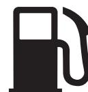
エンジンスイッチが“ON”的とき、燃料残量が2WD車は約4.5ℓ以下、4WD車は約5.5ℓ以下になると、燃料残量警告灯が点滅した後、点灯します。
