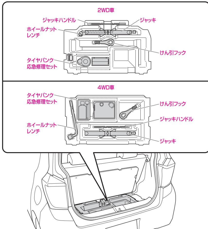
ジャッキ、工具、タイヤパンク応急修理セットは、ラゲージルーム内のラゲージアンダーボックスに収納しています。
