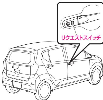
電子カードキーを携帯し、リクエストスイッチを押すと、すべてのドアが施錠・解錠されます。
