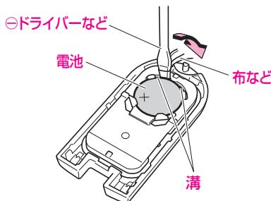
▼ 電子カードキーの部品がばらけたときは図を参考に組み付けてください。
