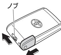
2. 電子カードキーのノブを矢印の方向にスライドさせたまま、カバーを外します。
