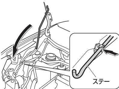
2. ボンネットを静かに下げる、手で押さえるようにして閉めます。
