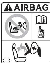
助手席エアバッグの有無にかかわらず、助手席にベビーシートを取り付けたり、チャイルドシートを後ろ向きに取り付けないでください。
