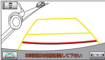
5 音声で案内されたら、ハンドルをまっすぐ（直進状態）にしたまま、緑の縦線が隣に駐車している車の後端に合う位置まで後退し、止まる。
