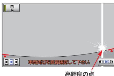
※スミヤ現象：高輝度の点（車体に反射した太陽等）がカメラに映るとその点の上下（縦方向）に尾を引く現象。
