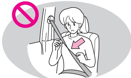
正しい運転姿勢でもシートベルトがねじれていったり、ゆるんでいたり、確実にロックをしていない場合には、衝突したときなどに、シートベルトが十分な効果を発揮せず重大な傷害におよぶか、最悪の場合死亡につながるおそれがあります。
