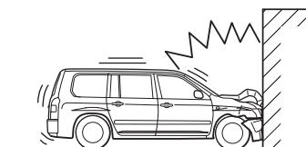
●衝突時に変形・移動しないコンクリートのような固い壁に正面衝突したときであっても、衝突速度が約25km/h以下のときは作動しない場合があります。
