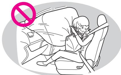
■助手席SRSエアバッグ装着車では、お子さまを助手席SRSエアバッグの前に立たせたり、ひざの上に抱いたりした状態では走行しないでください。
