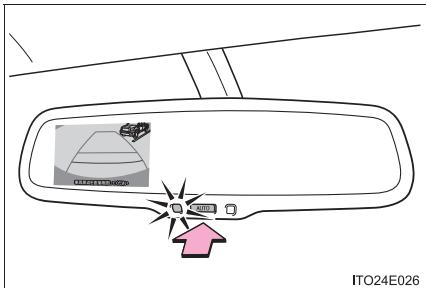
バックモニターの画面が表示されているとき、インナーミラーの AUTO ボタンを押して、画面の ON モードと OFF モードを切り替えることができます。
