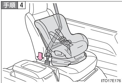
チャイルドシートにシートベルトを取り付け、プレートをバックルに“カチッ”と音がするまで挿し込む。ベルトがねじれていないうにする
