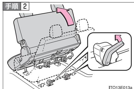
左右いずれかのロック解除レバーを引いて、シート脚部のロックを解除し、リヤシート後部を持ち上げる
