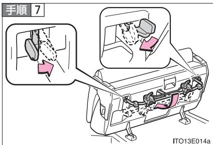
左右のレバーを内側に引いてロックを解除し、シート脚部を折りたたむ
