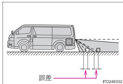
乗車人数、積載量などにより車が傾いているときは、実際の距離、進路と誤差が生じます。
