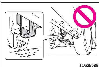
図のマウントハンガーにジャッキをかけないでください。マウントハンガーが破損するおそれがあります。
