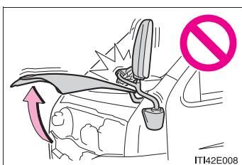
●電動アウターミラー非装着車は、ボンネットを開ける前に、助手席側アウターミラーが復帰状態になっていることを確認してください。格納状態のままボンネットを開けると、ボンネットとアウターミラーが損傷するおそれがあります。
