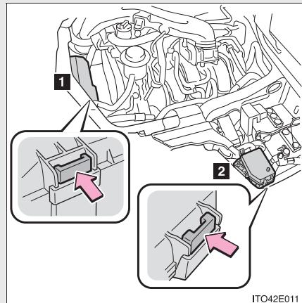
エンジン点検口(→P. 292)を開けて、ツメを押しながら、カバーを持ち上げる
