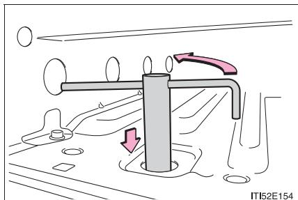
スペアタイヤレンチを使って、スペアタイヤ格納具がフックからはずせる程度にボルトをゆるめる
