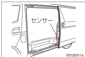
センサーを刃物などの鋭利なもので傷付けないよう注意してください。センサーが切断されると自動で閉めることができなくなります。
