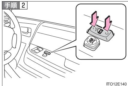
シフトレバーを P または N に入れ、ドアロックスイッチの LOCK 側または UNLOCK 側を約 5 秒間押して離す
