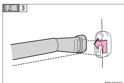
セパレーターバーの取り付け部(助手席側)を引き上げ、セパレーターバーを取りはずす
