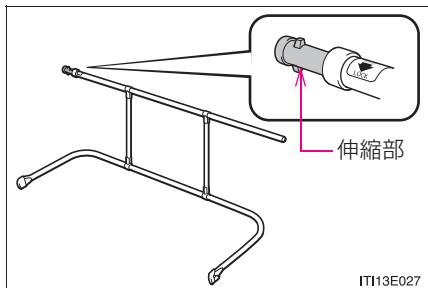
セパレーターバーの伸縮部が、必ず運転席側になるように取り付けます。
