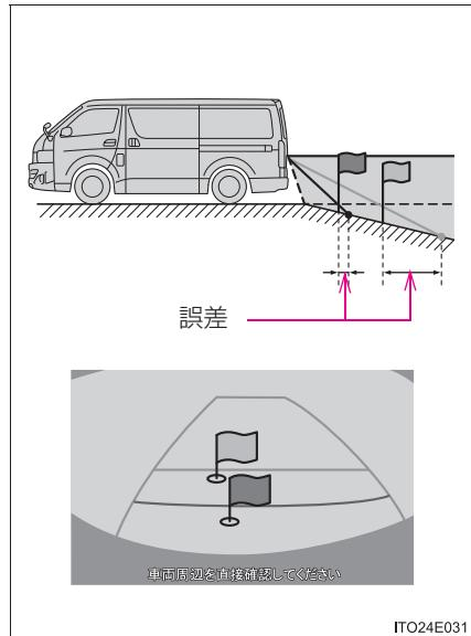
実際の距離よりうしろに距離目安線が表示されます。そのため、下り坂にある障害物は、実際より近くにあるように見えます。同様にガイド線と実際の路面上の進路にも誤差が生じます。
