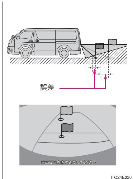
実際の距離より手前に距離目安線が表示されます。そのため、上り坂にある障害物は実際より遠くに見えるように見えます。同様にガイド線と実際の路面上の進路にも誤差が生じます。
