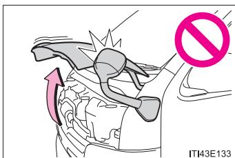
●電動アウターミラー装着車は、ボンネットを開けるときに補助ミラーにあたる場合は、補助ミラーの位置を調整してください。補助ミラーの位置によっては、ボンネットがあたり、ボンネットと補助ミラーが損傷するおそれがあります。
