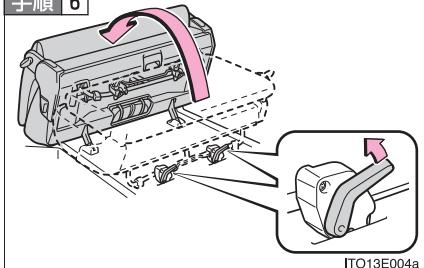
左右いずれかのロック解除レバーを引いて、シート脚部のロックを解除し、リヤシート全体を前方に起こす
