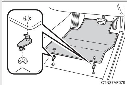
フロアマット付属の固定フック（クリップ）を使用して固定してください。
