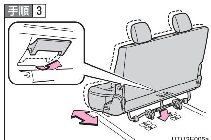
スライドレバーを引いてシートを前後に移動させ、シートをフロアに押し付けてロックする
