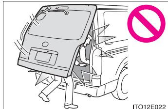
● 半開状態で使用すると、バックドアが落ちて重大な傷害を受けるおそれがあります。特に傾斜地では、平坦な場所よりもバックドアの開閉がしにくく、急にバックドアが開いたり閉じたりするおそれがあります。必ずバックドアが全開で静止していることを確認して使用してください。
