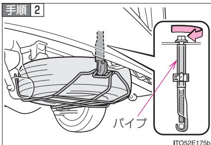
パイプががたつかなくなるまでボルトを締め付けたあと、さらに1/4回転以上締め付ける
