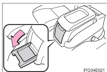
センターコンソールボックスの前面部分を倒すと、トレイとして使用できます。
