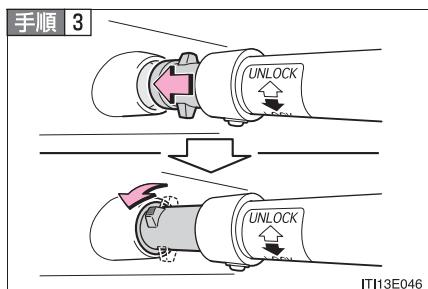
上側のセパレーターバー取り付け部（運転席側）をブラケットに取り付ける
