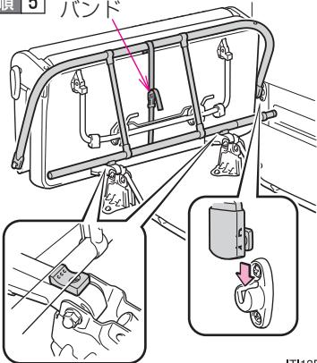
セパレーター・バー(Dタイプ:→P. 74)を取りはずし、図のように格納する
