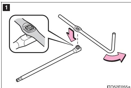
1 ジャッキハンドルの穴部を使い、ジャッキハンドル延長用バーの接続用ボルトをゆるめる
