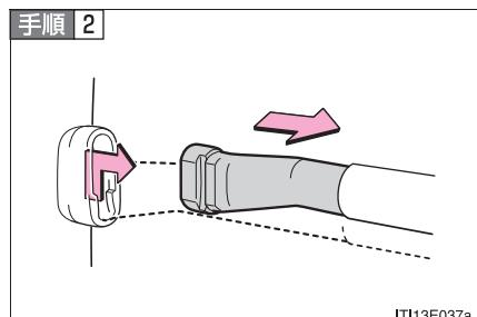
セパレーターバーの取り付け部(運転席側)を引き上げ、内側に縮める
