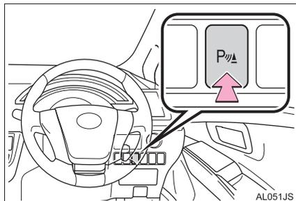
1 パワースイッチが ON モードのときクリアランスソナースイッチを押す。
