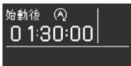
エンジンスイッチをイグニッションONモードからOFFにするまでのアイドリングストップ時間(Stop & Startシステムによるエンジン停止時間)を通算で表示します。
