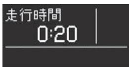
エンジンスイッチをイグニッションONモードからOFFにするまでの走行時間を表示します。
