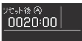
リセットしてからのアイドリングストップ時間(Stop & Startシステムによるエンジン停止時間)を通算で表示します。
