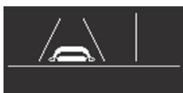
LDA（レーンディバーチャーアラート）(→ P. 198) の作動状況を表示します。
