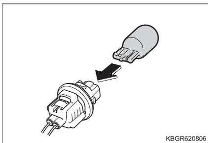
**5** ソケットを回して取り付ける
