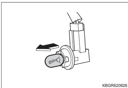
**5** 新しい電球を取り付ける
