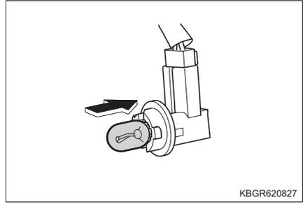
**6** ソケットを回して取り付ける
