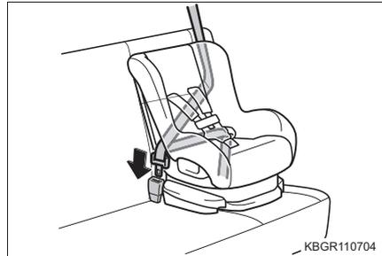
3 チャイルドシートにシートベルトの固定装置が備わっていない場合は、ロックングクリップ (別売) を使用して固定する
