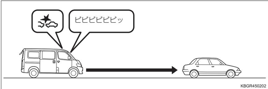
前方車両※・歩行者に対し、衝突の危険性があると判断したときに、ブザーとディスプレイの表示（→ P. 152）で運転者に注意喚起して衝突回避操作を促します。
