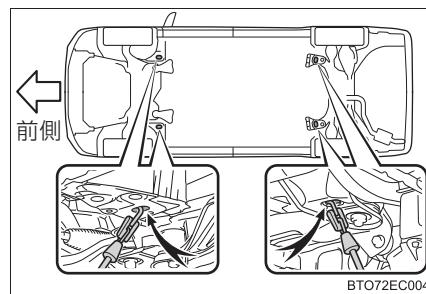
鎖やケーブルなどを使用して車両を固縛する場合は図に黒く示す角度が45°になるように固縛する
