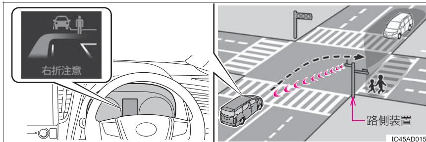
ITS Connect は、道路上に設置された DSSS\* 用路側装置や通信機を搭載した車両と無線通信することで、見通しが悪い交差点の交通状況などの情報を受信します。
