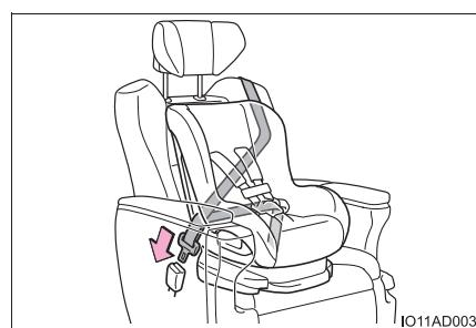
**4** チャイルドシートにシートベルトの固定装置が備わっていない場合は、ロッキングクリップ(別売)を使用して固定する
