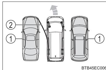
走行中にサイドセンサーで障害物を感知します。車両が移動して障害物がサイドセンサーで感知できない位置にあった場合も、車両の位置を計算することで障害物の位置を算出し、車両の経路内に障害物がある場合に、巻き込み警報機能が作動します。
