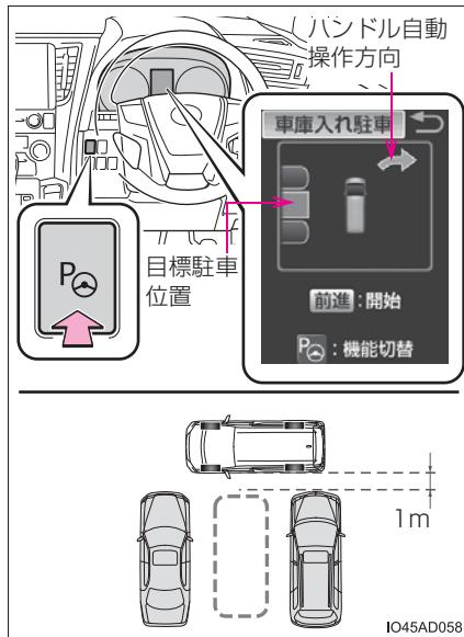
2 通常の運転操作の姿勢をとり、ハンドルに力を加えないように軽く手を添え、前方および周辺の安全を直接確認し、ブレーキペダルを踏んで車速調整しながら、ゆっくり前進すると「“ピー”」という音が鳴り、メーター内のインテリジェントパーキングアシスト2表示灯が点灯し、アシストが開始されます。
