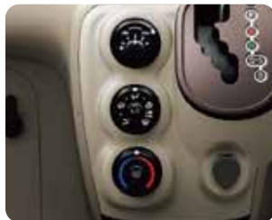
マニュアルエアコン & ダイヤル式ヒーターコントロールパネル
