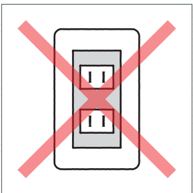
接地極(アース)のないコンセント
